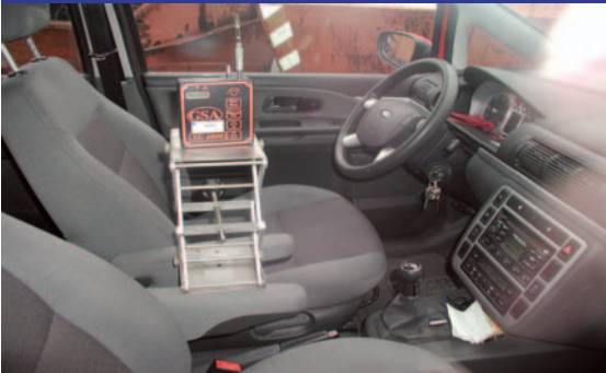
Innenraummessung auf Schadgase im Fahrzeug
